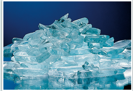
Kaliwasserglas – hier in Form von Stückglas – bildet das hochwertige Bindemittel
