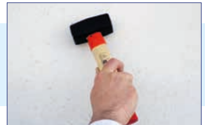
6. Klop- und Hörprobe Hohllagen ermitteln
