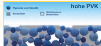
Pigmente und Füllstoffe sind nicht mehr vollständig von der Bindemittelmatrix umhüllt.
