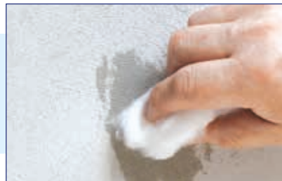
5. Lösemitteltest Prüfung auf mineralisch oder kunstharzgebundenen Untergründen
