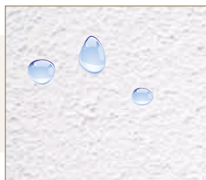
Beim Spreiteffekt treffen die Wassertropfen auf die hydrophile Oberfläche.
