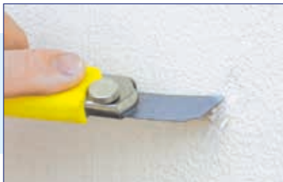
1. Kratzprobe Prüfung der Oberflächenfestigkeit
