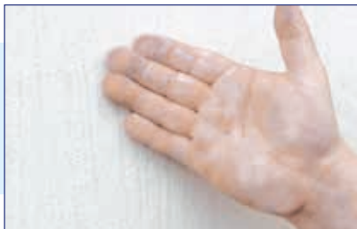
4. Wischprobe Prüfung kreibender Flächen
