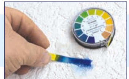
3. Alkalitätsprüfung Mit neutralem Wasser und Indikatorpapier
