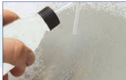
2. Benetzungsprobe Prüfung der Saugfähigkeit
